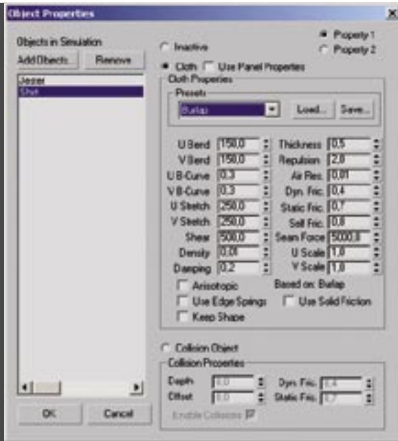
[02] Im „Object Properties“-Dialog können Sie definieren, ob es sich bei der selektierten Geometrie um ein inaktives, ein Cloth- oder auch Collision-Object handeln soll
