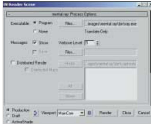
Die letzte Mental-Ray-Option im Render-Dialog bietet beispielsweise Prozess-Einstellungen für ein verteiltes Rendering
