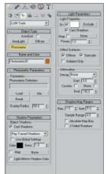
Der photometrische Licht-Modifier hilft beim Einbinden von IES-Daten
