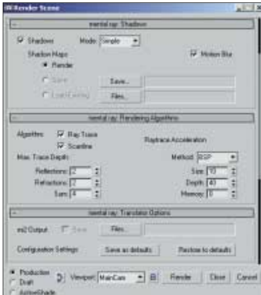
Einstellungen wie Sample-Qualität, Kamera-Effekte oder indirekte Illuminierung gehören zum Optionsumfang wie auch Schatten-, Rendering-Algorithmus und die MI-Datei-Ausgabe (im Bild)
